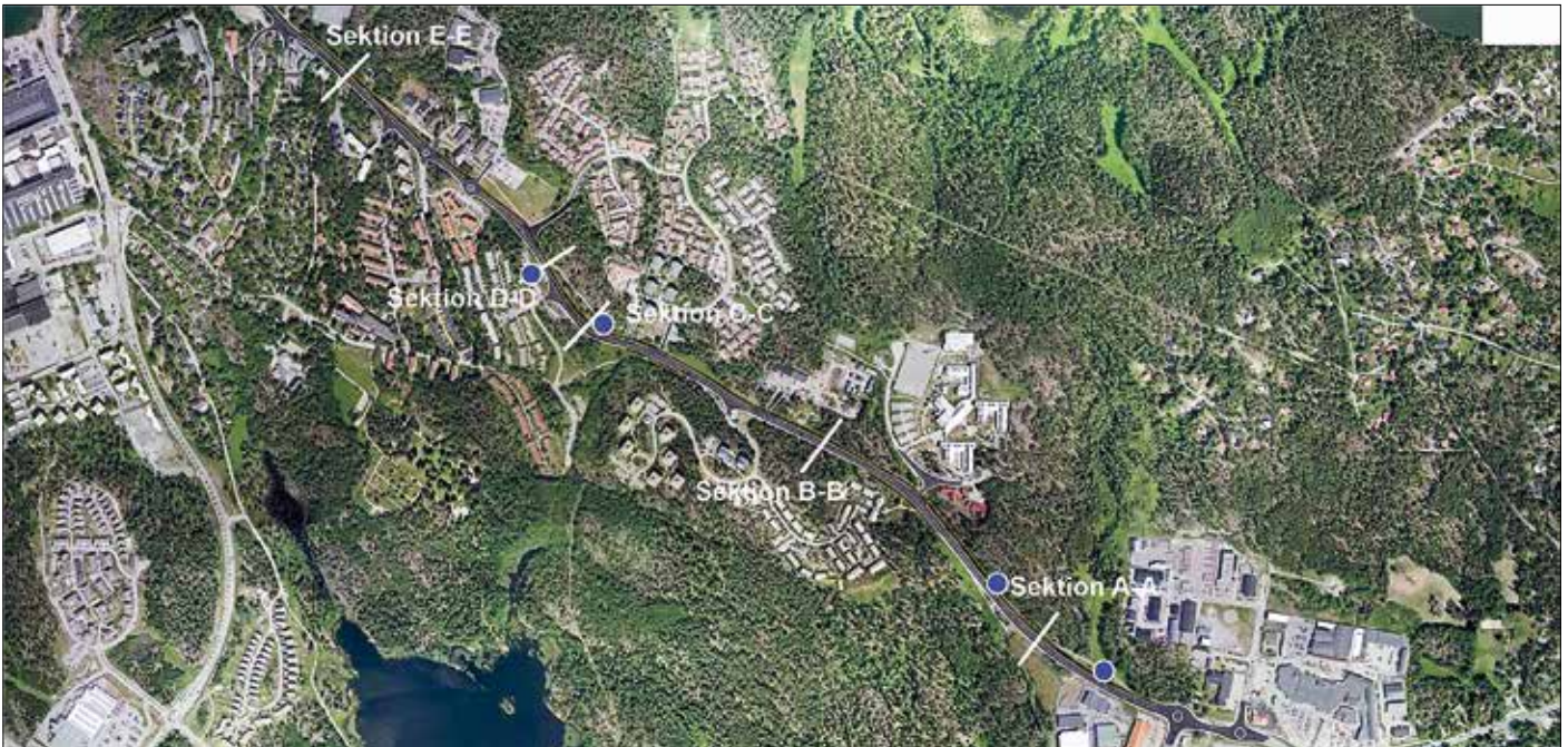
Exempel på åtgärd: Busskörfält i riktning mot Gustavsbergs centrum på Skärgårdsvägen. Uppskattad tidsvinst: cirka två minuter och 40 sekunder (mot Nacka trafikplats). Kostnad: cirka 22 miljoner kronor. Vägghällare: Värmdö kommun.
